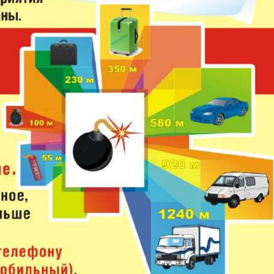
**РЕКОМЕНДУЕМЫЕ ЗОНЫ (В МЕТРАХ) ЭВАКУАЦИИ И ОЦЕПЛЕНИЯ ПРИ ОБНАРУЖЕНИИ ВЗРЫВНОГО УСТРОЙСТВА ИЛИ ПОДОЗРИТЕЛЬНОГО ПРЕДМЕТА.**
