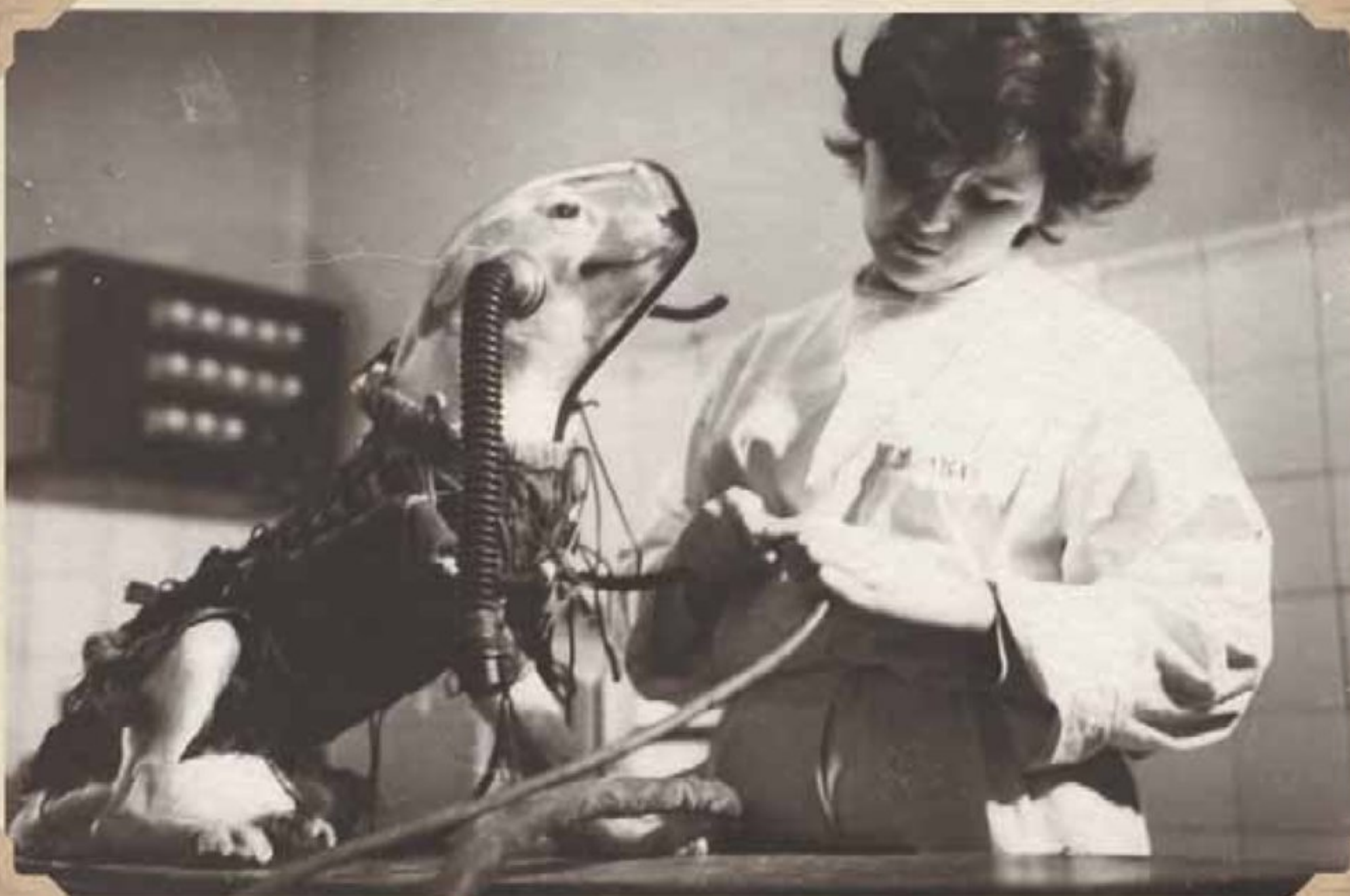
Укрепление датчиков для снятия медицинских показателей во время полёта на геофизической ракете. Середина 1950-х гг.
